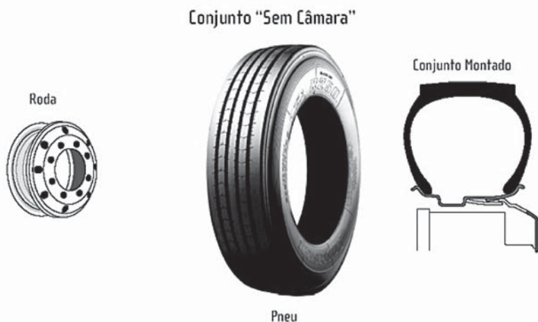
Figura 4: Pneu – Conjunto sem câmara Fonte: Manual técnico Bridgestone, 2008
