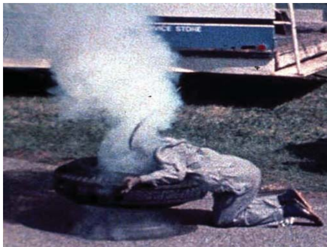
Foto 4: Falha na montagem da roda Fonte: Manual técnico da Bridgestone, 2008
