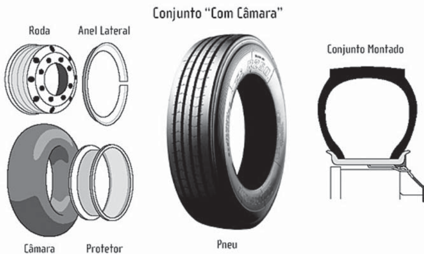
Figura 3: Pneu – Conjunto com câmara Fonte: Manual técnico Bridgestone, 2008
