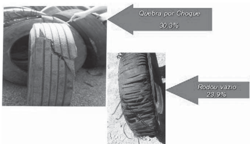
Foto 6: Exemplos de sucateamento Fonte: Manual técnico Bridgestone, 2008
