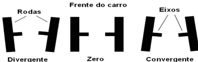
Figura 10: Ângulo de convergência e divergência Fonte: O autor, 2009
