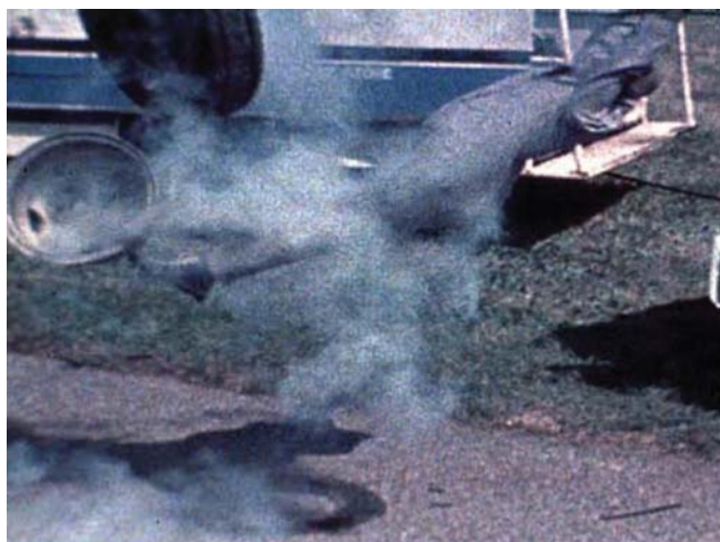
Foto 5: Explosão ocasionada pela falha na montagem da roda Fonte: Manual técnico Bridgestone, 2008
